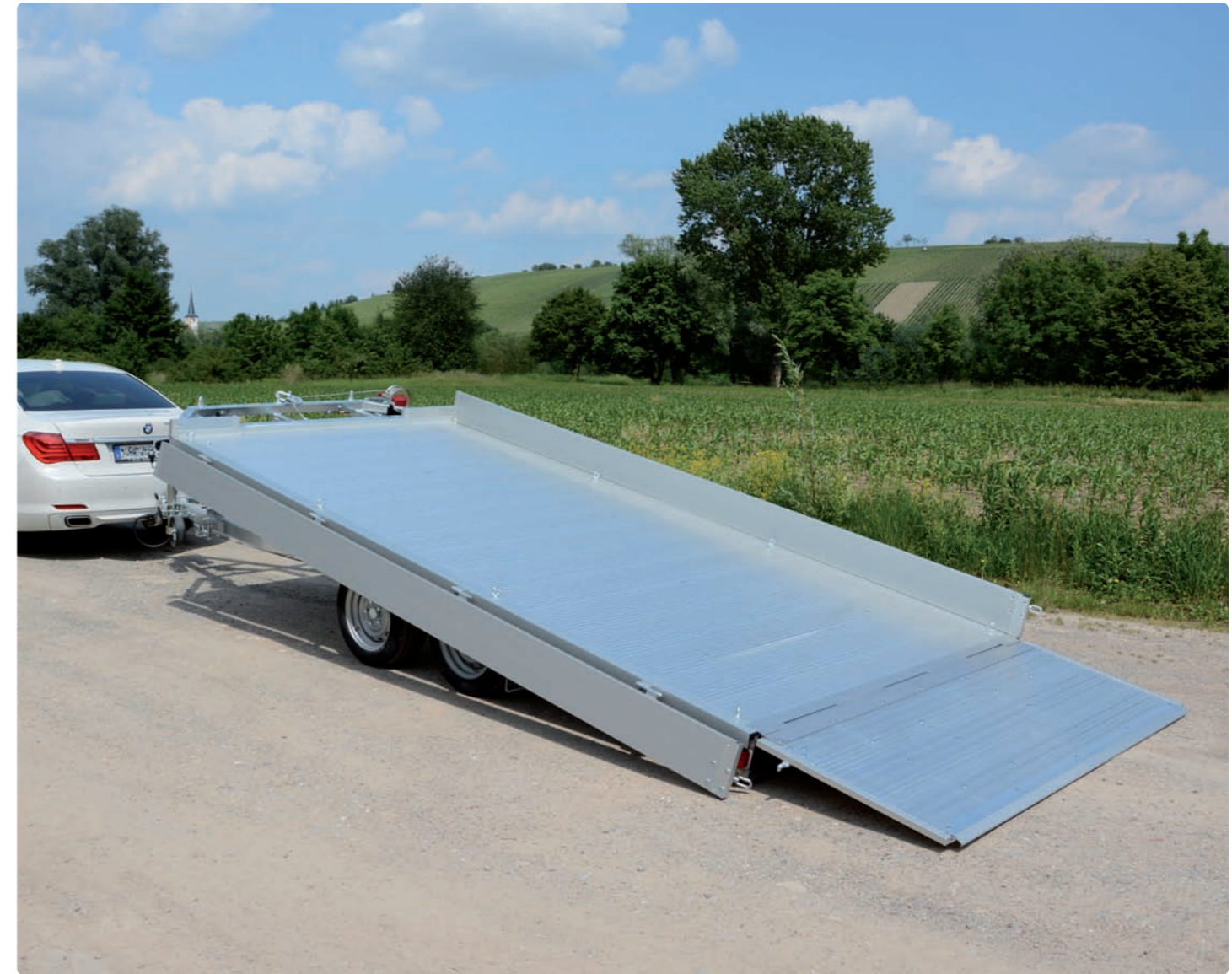
MKHL 2700 Aluprofilboden geschlossen, Auffahrrampe (Höhe: ca. 600 mm), Bordwände seitlich 200 mm hoch und klappbar; Zubehör: Winde MKHL 2700 Plancher intégral en profilés d'alu, rampe en alu (hauteur : 600 mm environ), ridelles latérales rabattables (hauteur : 200 mm) ; option : treuil MKHL 2700 Closed aluminium platform, aluminium ramp (height: approximately 600 mm), fold-away side panels right / left (height: 200 mm); optional extra: winch
