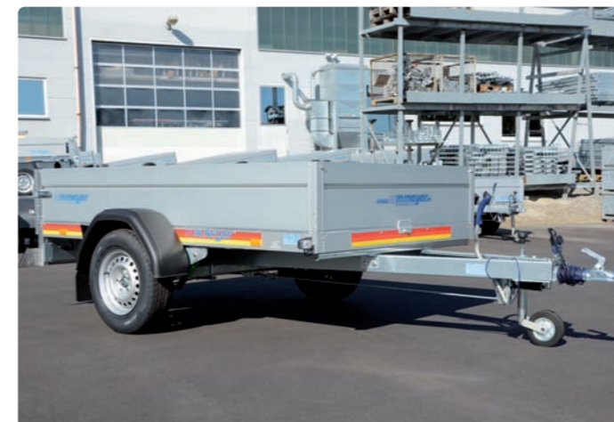
Zubehör: Aluordwanderhöhung abnehmbar Option : ridelles supplémentaires amovibles en alu Optional extra: increase in aluminium panel height, can be taken off
