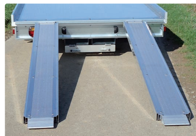
2 Aluminiumauflaufschienen (ca. 2.700 x 300 mm) 2 rampes en aluminium (2.700 x 300 mm environ) 2 aluminium skids (2,700 x 300 mm approx.)
