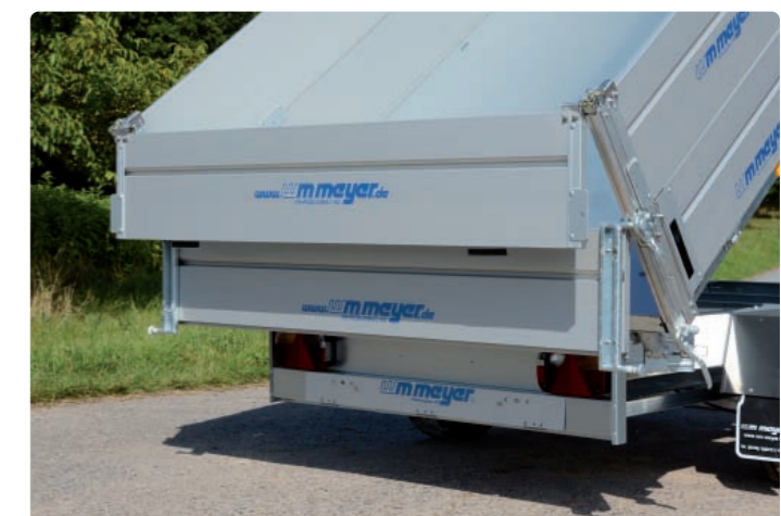
Zubehör: Alubordwanderhöhung abnehmbar; untere Heckwand links: aufgeklappt; untere Heckwand rechts: aufgeschwenkt Options : ridelles supplémentaires en aluminium qui peuvent être enlevées ; illustration des 2 manières d'ouvrir la ridelle arrière basse Optional extra: additional aluminium side panels which can be taken off; illustration of the 2 ways of opening the lower rear panel
